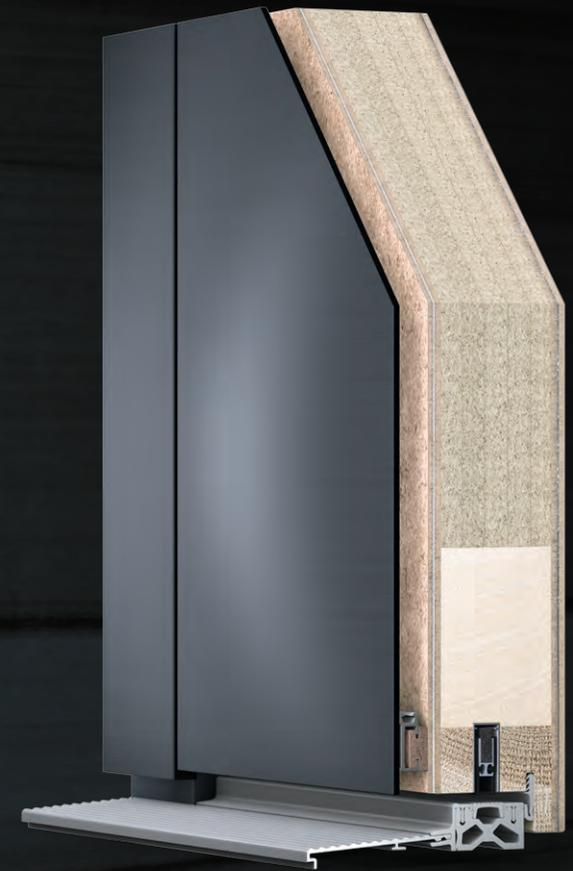
Détail du seuil: seuil à séparation thermique (type Hebgo 173) avec joint abaissant dans le battant. Le joint abaissant est standard pour toutes les portes finies!
