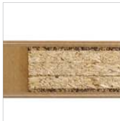
Insonorisation par structure multicouche.
