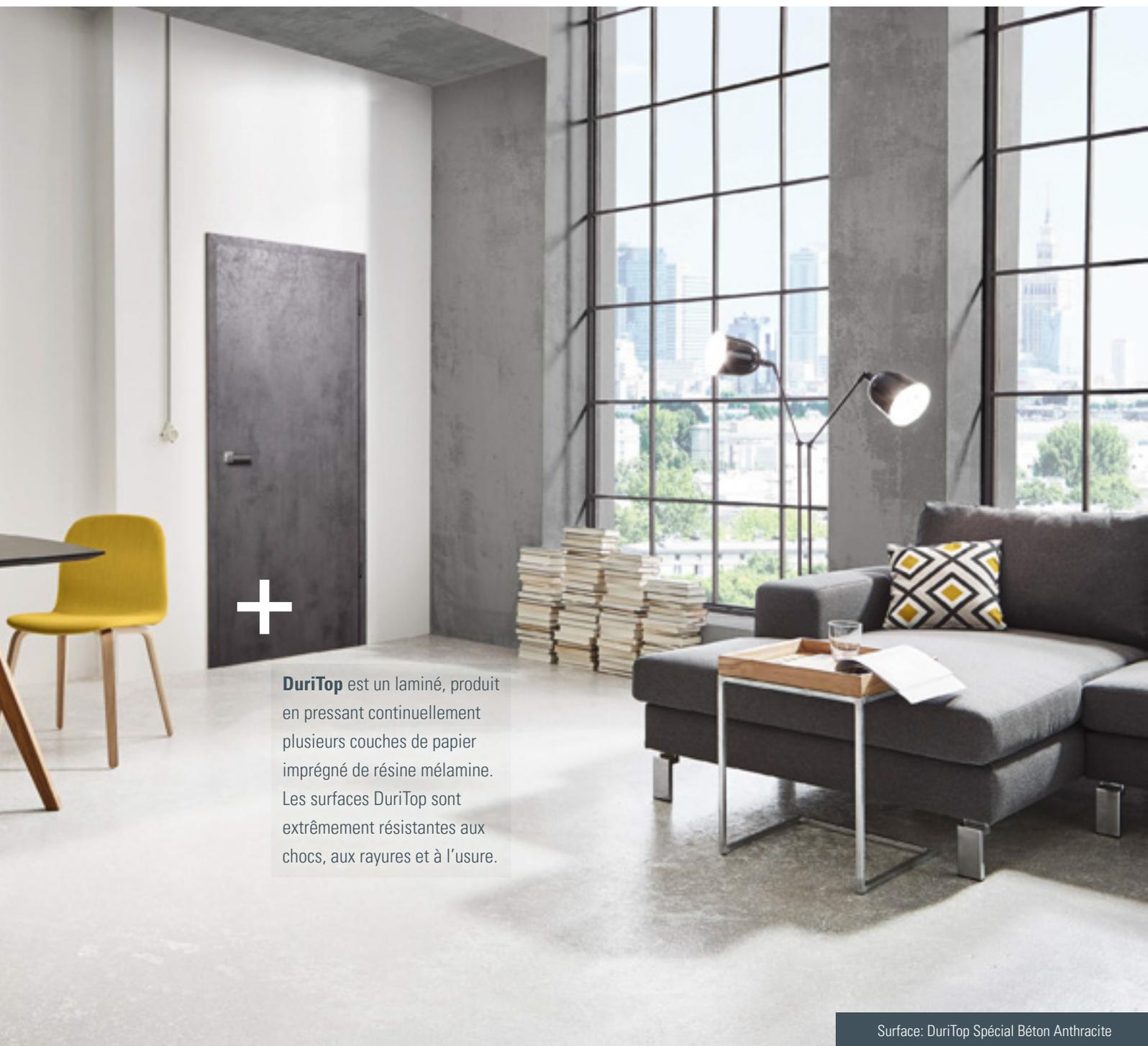
**DuriTop** est un laminé, produit en pressant continuellement plusieurs couches de papier imprégné de résine mélamine. Les surfaces DuriTop sont extrêmement résistantes aux chocs, aux rayures et à l'usure.
