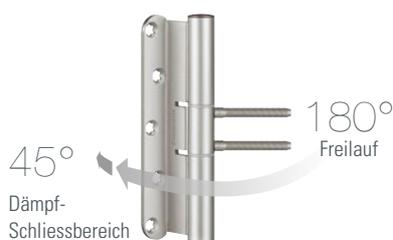
Variant SC (Self Close) ist ein innovatives Bandsystem, das gefälzte Türen selbstständig, gedämpft und kontrolliert schliessen lässt. Die Tür wird einerseits beim Schliessvorgang abgedämpft und durch eine selbsttätige Schliessung ins Schloss geführt, während sie andererseits, wie gewohnt, im geöffneten Zustand stehen bleibt.
